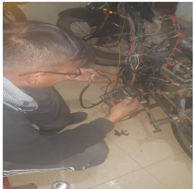
Fig. 1: Prueba de CDI con multímetro.
