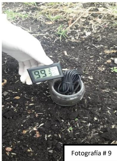
**Fotografía 9: Toma de humedad y temperatura de la muestra con termohigrómetro digital. (Imagen propia).**
