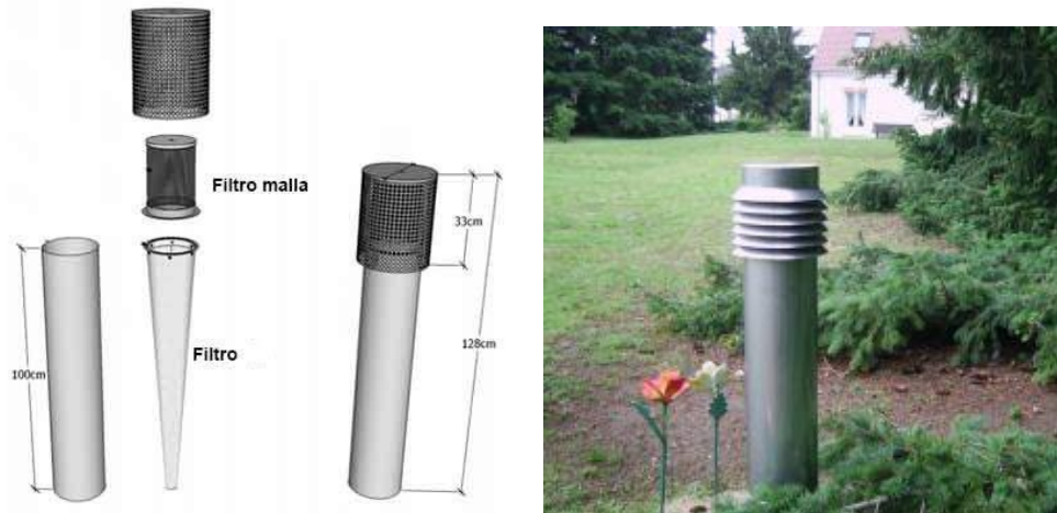
Figura 3-2. Punto de captación de aire y filtros ICTA
