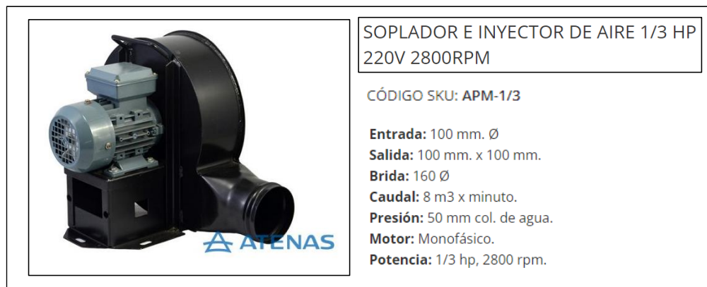
Figura 3-6. Soplador e inyector de aire para el ICTA
