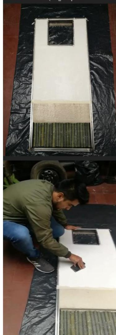
Después de una semana se le aplica la pintura ecológica de la línea ecológica Pintuco de color oro, no se evidencia ningún tipo de grieta o fisura en la estructura se mantiene con el detalle, el próximo paso va ser enviar una muestra del muro para que le hagan la prueba de resistencia y a si mismo saber cuánto peso soporta realmente y asegurar la calidad del laboratorio de materiales.
