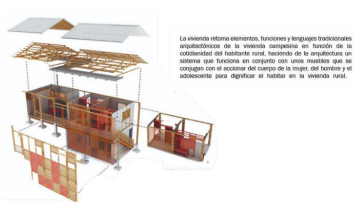
Imagen 12: Axonometría explotada componentes de la vivienda familiar productiva.
