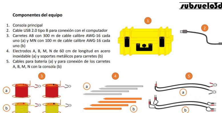
Figura 33: Componentes GeoAmp303 Fuente: (Subsuelo3d, 2017c).
