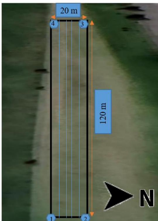
Figura 24: Configuración Wenner Fuente: Autoría propia
