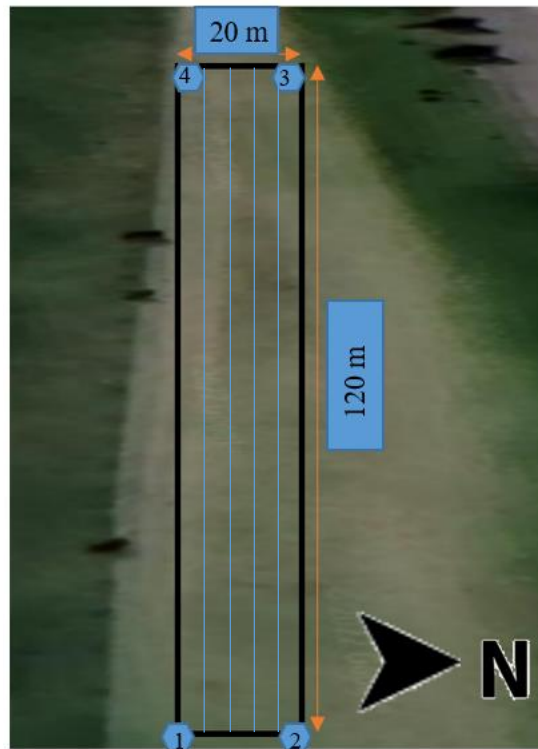
Figura 29: Configuración Schlumberger Fuente: Autoría propia
