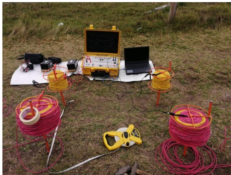
Figura 31: Configuración Schlumberger Fuente: Autoría propia
