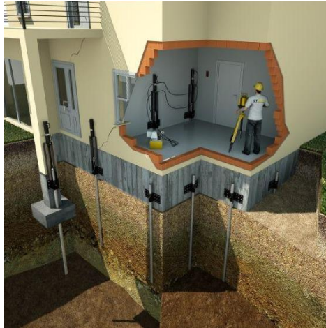
Figura 11. Micropilotes Para Hundimientos
