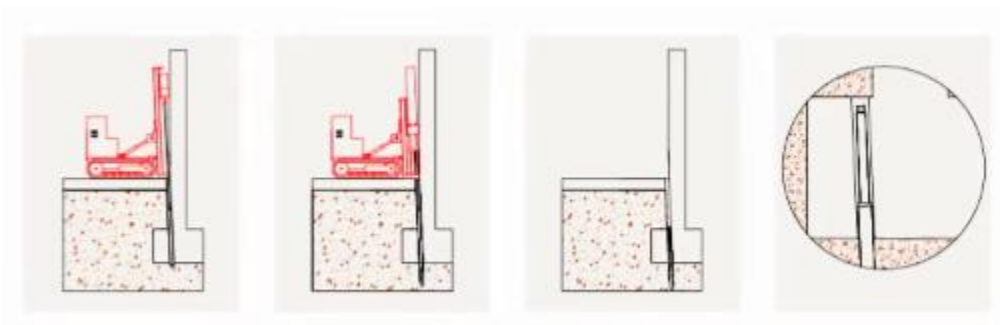
Figura 12. Recalce De La Cimentación En Un Edificio Histórico - Geonovatek
