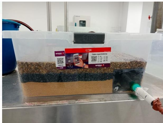
Figura 6: construcción del humedal con los sustratos
