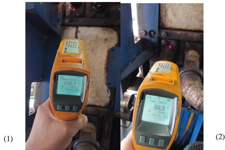
*Nota.* (1) Temperatura a la entrada del calentador. (2) Temperatura a la salida del calentador. Tomado en casa de tratamiento de planta de generación.
