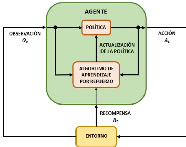
*Nota.* En este diagrama se ilustra de manera general la estructura de un algoritmo de aprendizaje por refuerzo. Fuente. (MathWorks, 2019)
