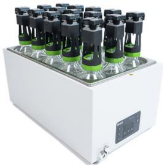
Figura 4. Unidad de incubación de muestras en reactores tipo Batch
