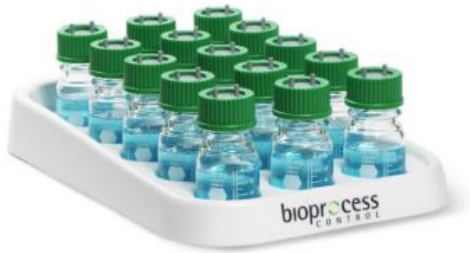
Figura 5. Unidad de absorción de CO 2 y otros gases obtenidos de la digestión anaeróbica
