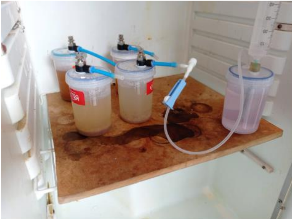
Figura 19. Montaje para evaluación del potencial de biometano
