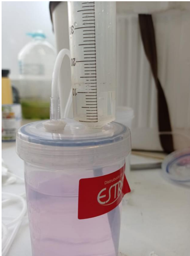
Figura 11. Primer prototipo de sistema de medición de biogás
