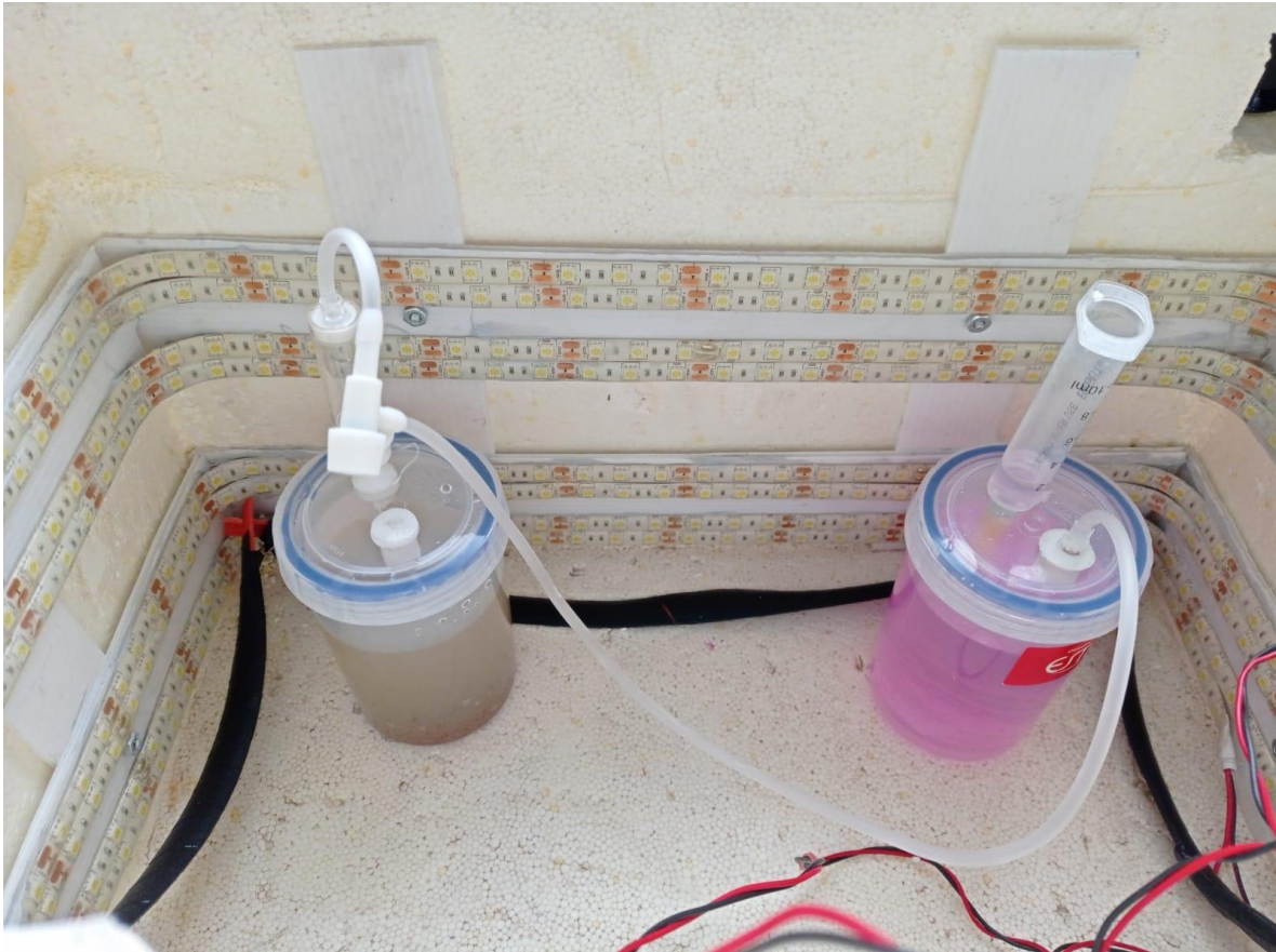
Figura 13. Primer ensamblaje del montaje para la determinación de BMP
