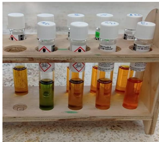
Figura 18. Determinación de mgDQO/L de los sustratos a evaluar (Tonalidad más cercana a verde muestra mayor concentración)
