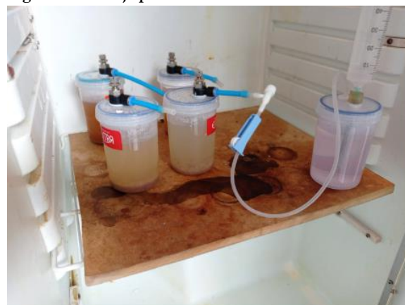
Figura 3. Montaje para la determinación de BMP
