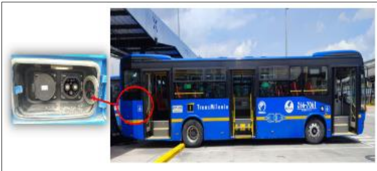
Figura 6-26: Ubicación puertos de carga alto voltaje
