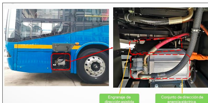
Figura 6-20: Ubicación bomba de dirección (lateral derecho)
