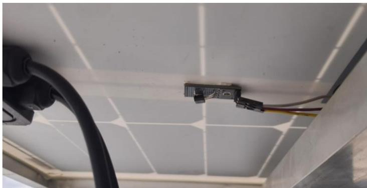
Figura 5-6: Ubicación del sensor de temperatura LM35 de tras del panel. Elaboración Propia.
