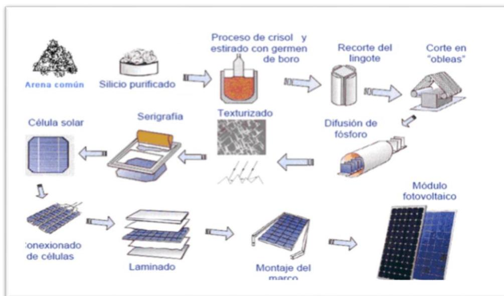
Figura 2-1: Etapas del proceso de fabricación de las celdas a base de silicio (Monocristalina y Policristalina), tomada de [18].
