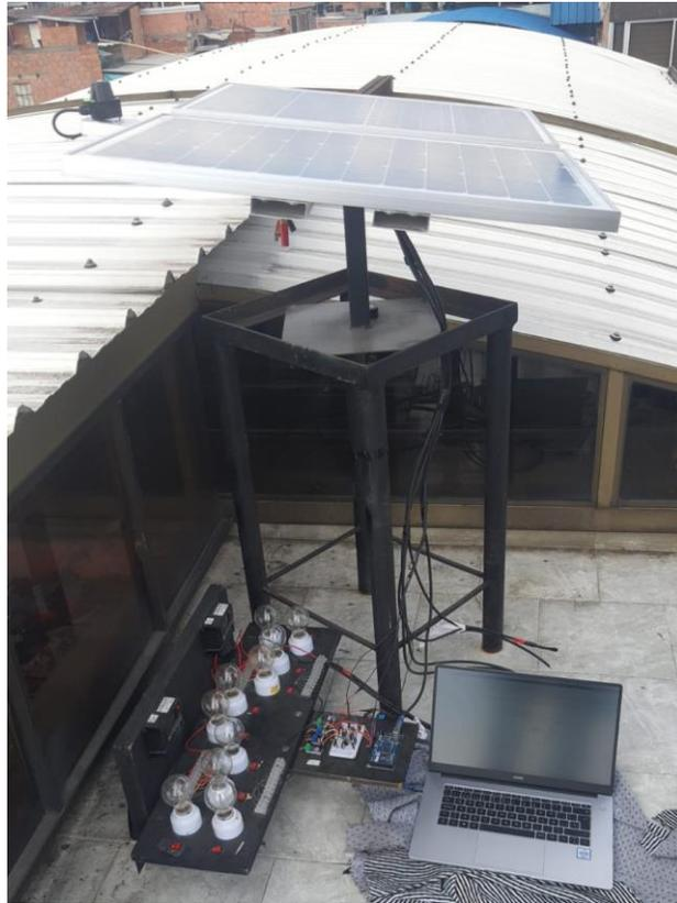
Figura 6-1: Montaje final de los paneles Solares, instrumentación electrónica y almacenamiento de datos. Fuente propia
