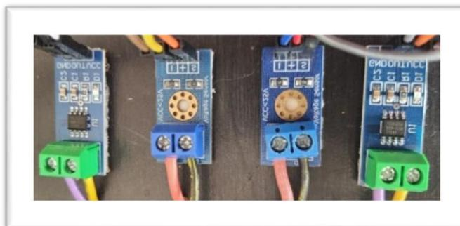
Figura 5-6: Distribución de los sensores de adquisición de variables eléctricas de los paneles solares, los sensores de los extremos corresponden al de corriente ASC712 y los 2 sensores del centro son los de voltaje FZ0430. Elaboración propia.
