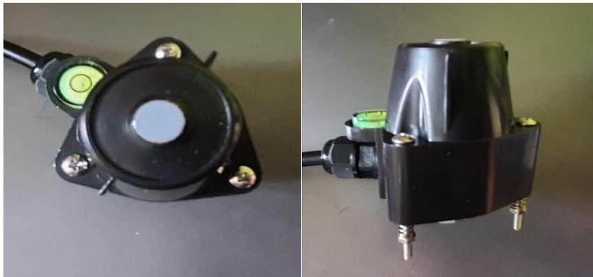
Figura 2-10: Piranómetro PYR, en dos ángulos diferentes. Fuente Propia
