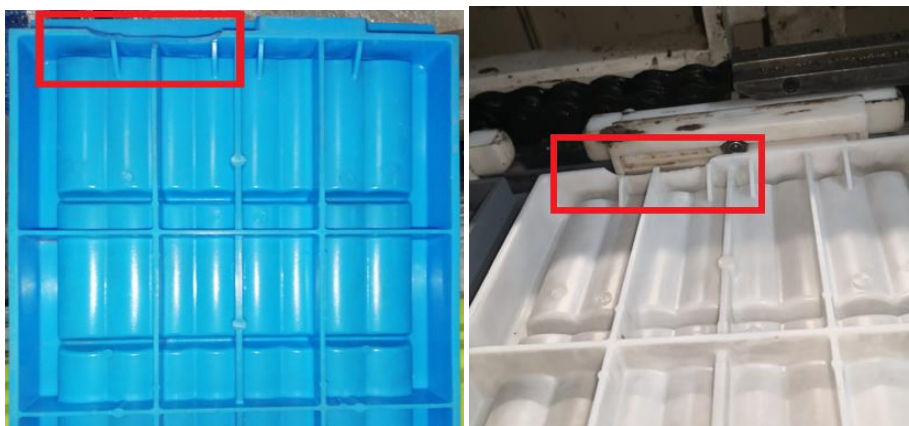
Figura 4.6 Ruptura de molde en área de sujeción- Fuente del autor
