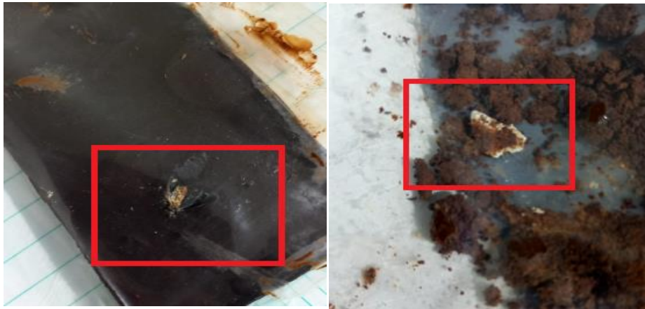
Figura 4.4 Producto contaminado con pieza de molde- Fuente del autor
