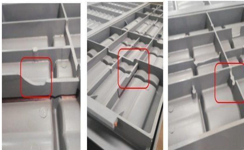
Figura 1.3. Moldes con fisuras dentro de la línea de producción, Imagen del autor.
