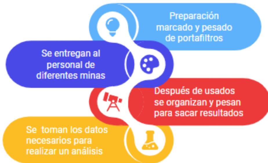
*Nota.* La figura muestra los pasos para toma de datos gravimétricos. Fuente elaboración propia.
