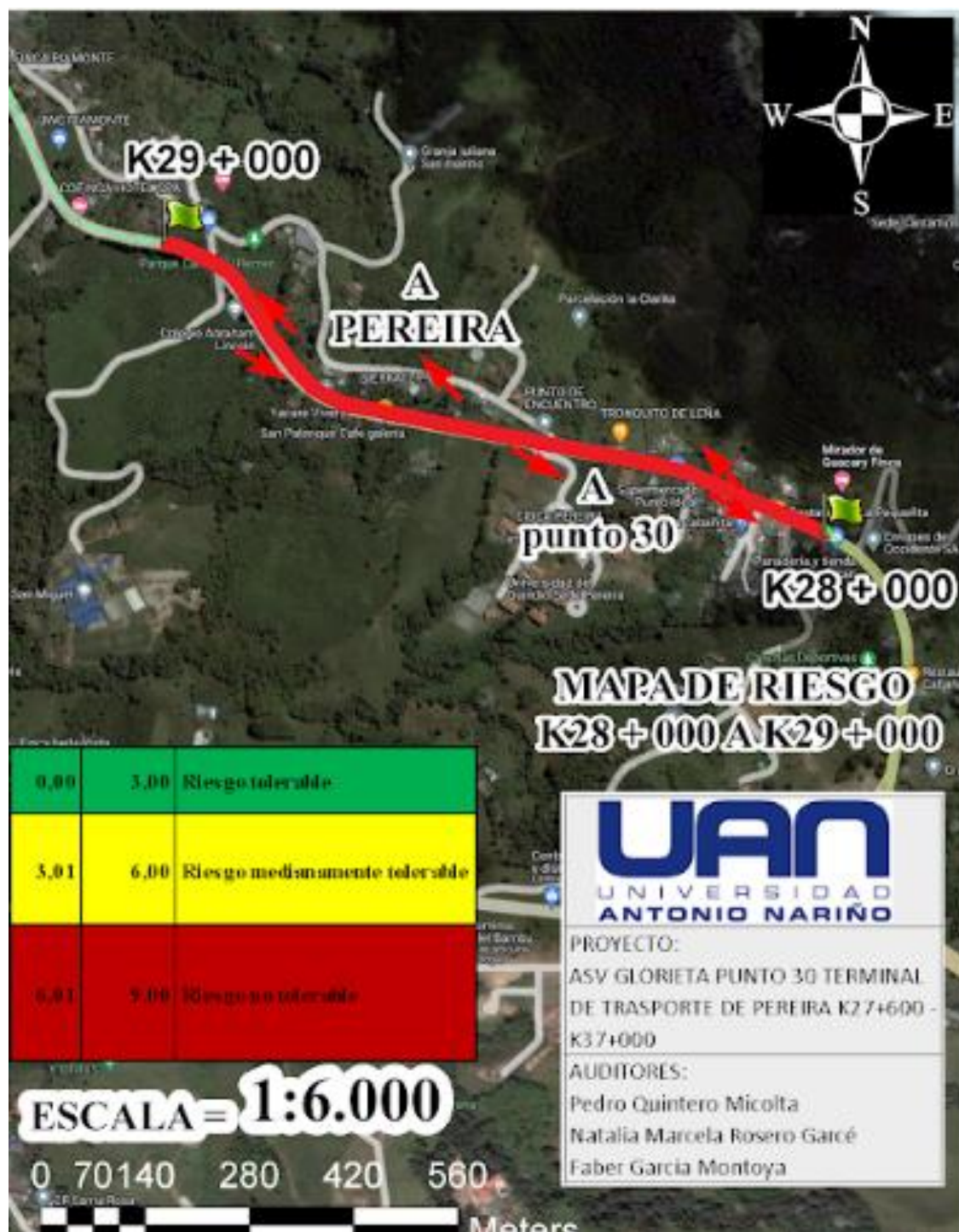
Figura 29. Mapas de riesgo Tramo 2 km 28 + 000 - km 29 + 000
