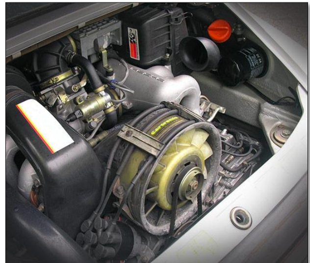
Figura 16. Sistema de Enfriamiento.
