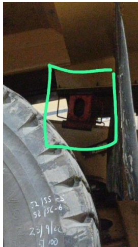
Ilustración 10 Espacio para instalación de la cuña.
