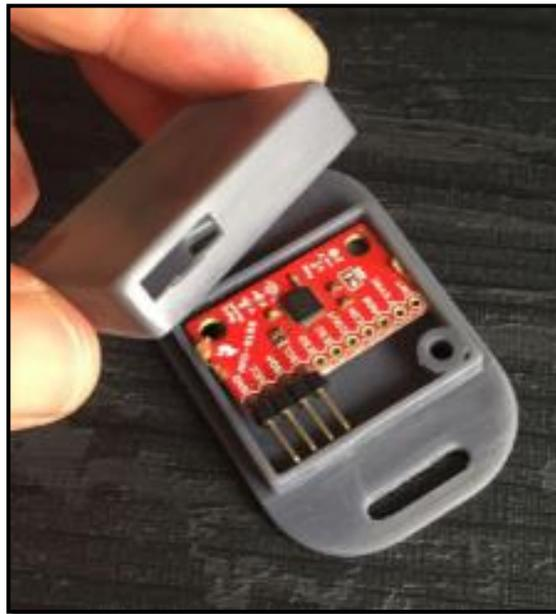
Fuente: Sensor inercial con estructura en resina Touch 1500 color gris. Tomada del autor.
