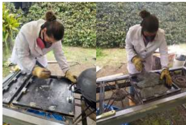
Fig. 16 engrasado del molde y vaciado del plástico.
