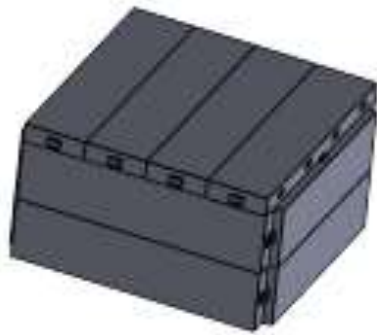
Fig. 3. Armado del caseton con las dos piezas.
