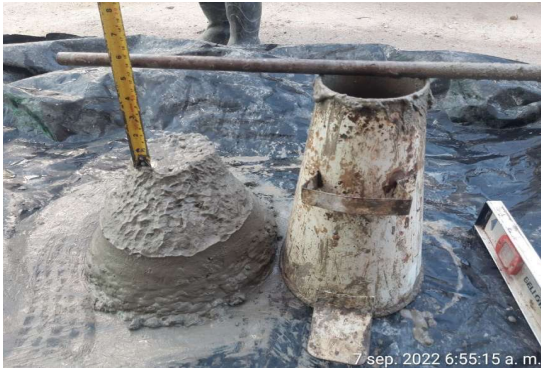
Descripción: ensayo de slum
