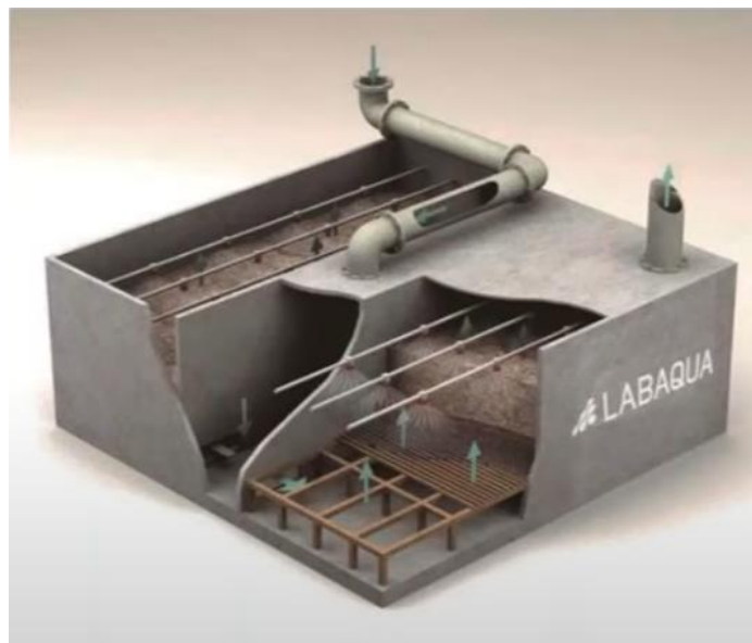
Figura 21 Esquema General de Biofiltro Biológico fuente: (labaqua,2020 ).
