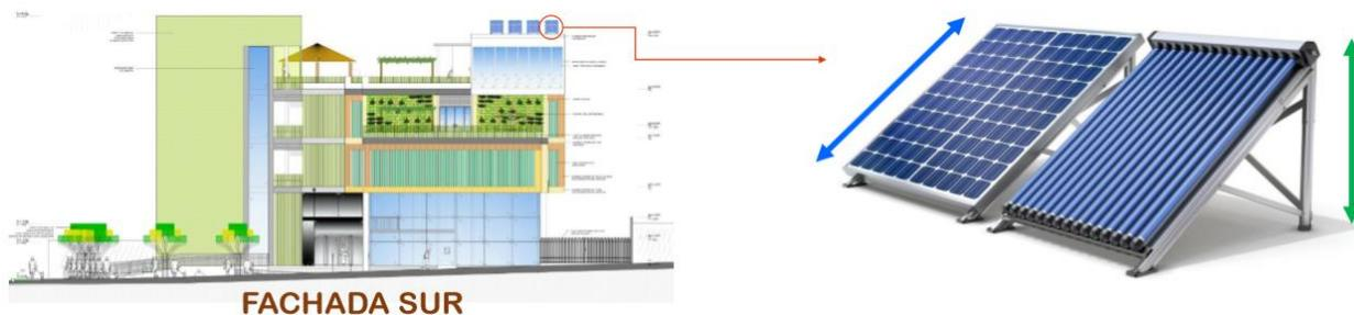
*Nota.* Instalación de paneles solares fotovoltaicas de Primera Generación Dimensión Alto 1.00 x Largo 2.00 a 30° grados de inclinación hacia la fachada Sur, sobre la cubierta sala audiovisuales, para captar, transformar y dar uso de aproximadamente el 15% del consumo de energía eléctrica.
