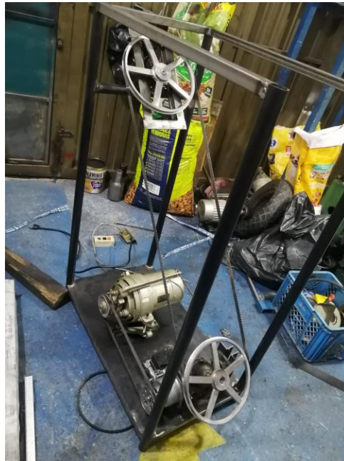
Figura 33. Esquema del ensamble final del sistema de potencia Prototipo I. Fuente (propia)
