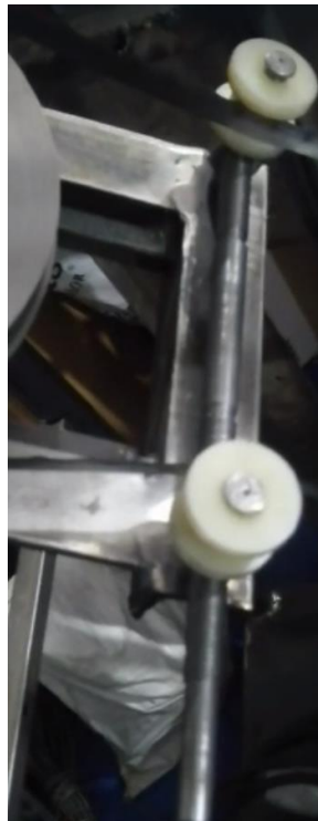
Figura 23. Guías de cinta sierra superiores en polímero. Fuente (propia)
