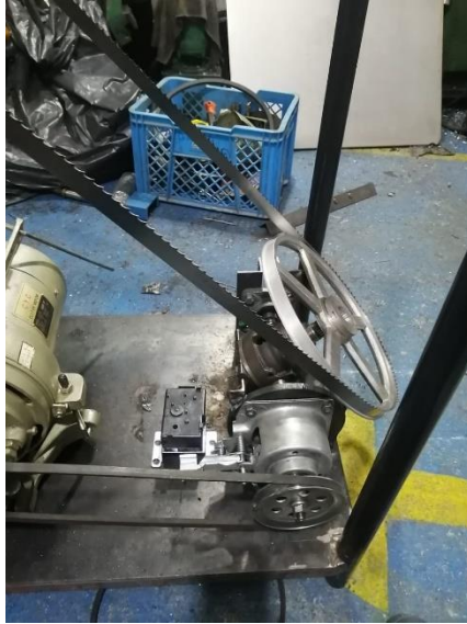
Figura 32. Multiplicador de Torque y caja de engranajes prototipo I. Fuente (propia)
