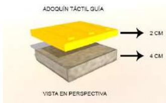
*Figura 101. Nota: Vista en planta del adoquín táctil guía. Fuente: Elaboración propia. (2019)*
