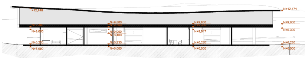
S-01 SECCIÓN LONGITUDINAL E-E' 1:100
