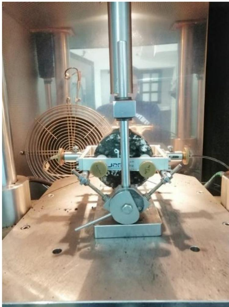
*Ilustración 5:* Urrea Fabian, 15 septiembre de 2022 - Preparación de muestras para ensayo de módulo resiliente, Bogotá.
