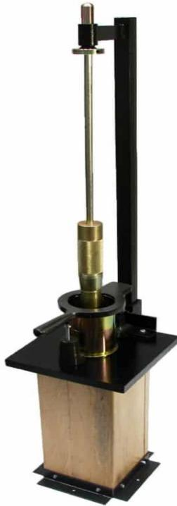
*Ilustración 4:* Martillo de operación mecánica Marshall (Equipo Manual de Compactación | Dirimpex, n.d.)
