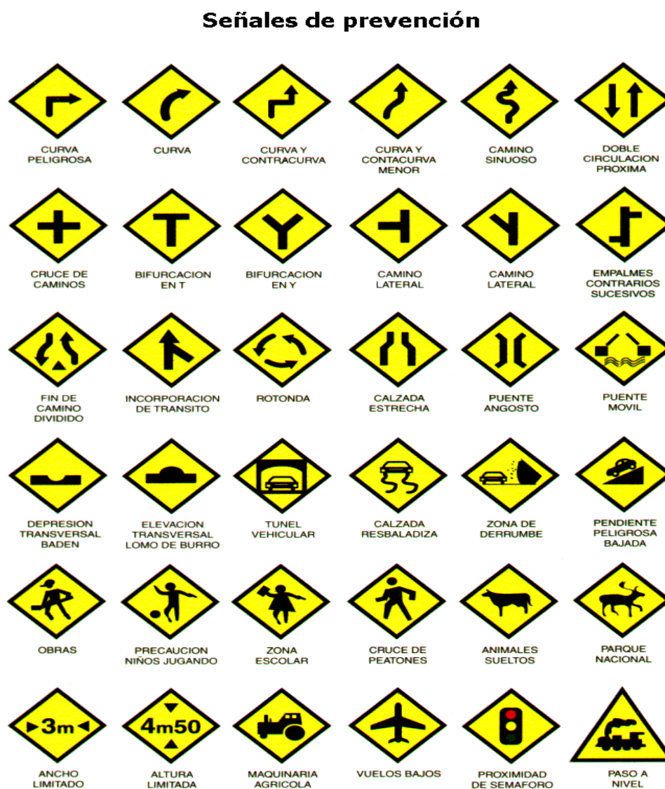
Figura 8. Señales de Prevención
