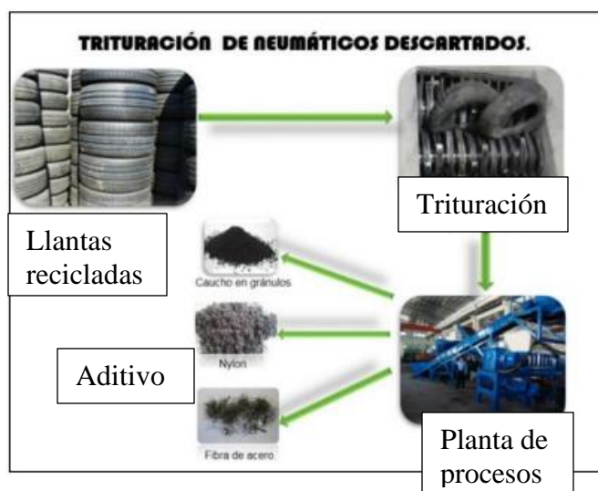
Figura N° 3. Proceso para obtener el caucho granular.
