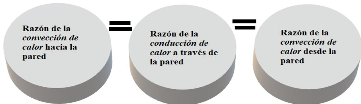
Nota: Red de resistencia térmica. Adaptado de (Zamrodah, 2016).
