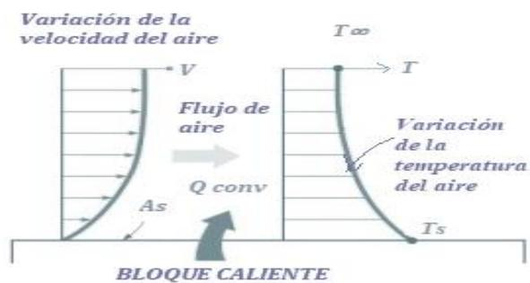
Nota: Transferencia de calor de una superficie que se encuentra a altas temperaturas hacia el medio ambiente por convección. Adaptado de (ÇENGEL, 2007).
