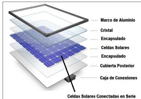
Figura 4. Partes de un panel solar.
