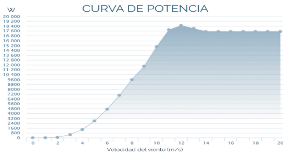
Figura 4-2: Curvas Potencia Vs Velocidad del Viento del Aerogenerador
