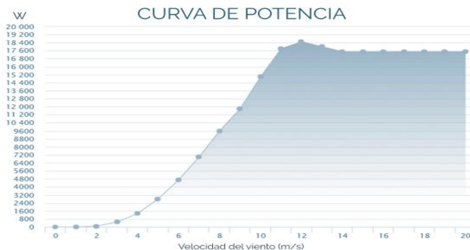
Figura 4-2: Curvas Potencia Vs Velocidad del Viento del Aerogenerador
