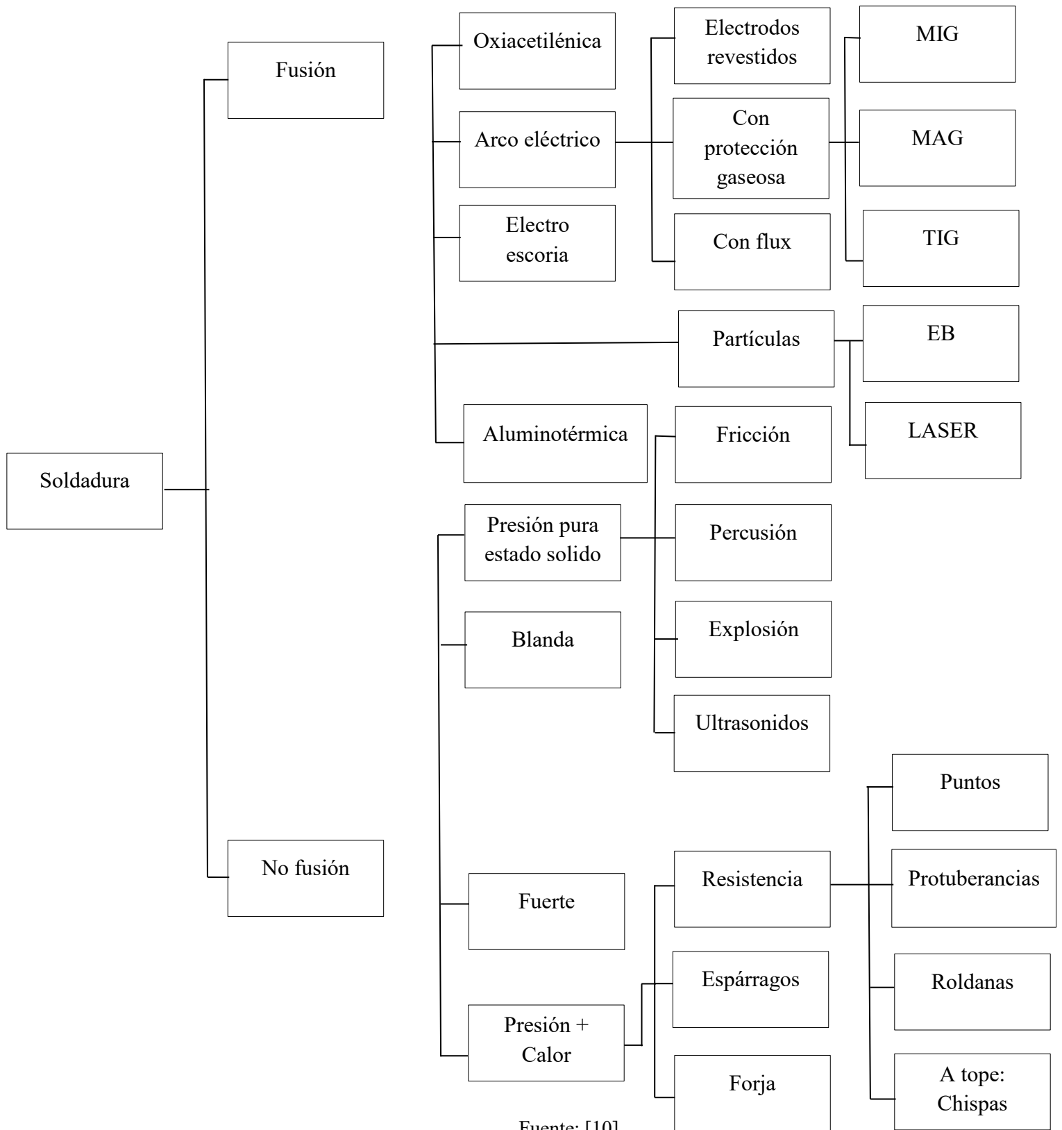
Figura 3. Procedimiento y clasificación de soldadura.
