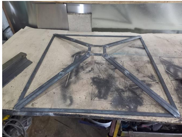
Ilustración 65. Estructura del techo. Fuente Autor
