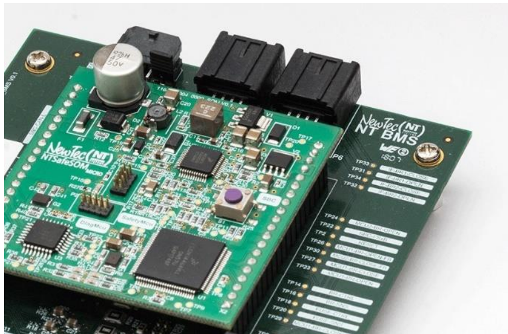
Ilustración 20. Sistema de gestión de la batería (BMS). Fuente [19]
