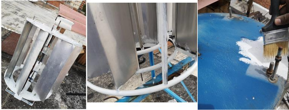
Figura 33. Pintado de la Estructura de Soporte de las Hélices
