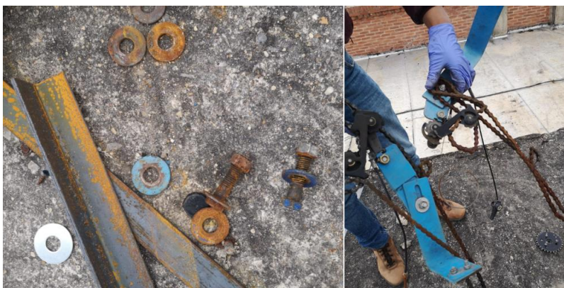
Figura 19. Cadena y Tornillos Oxidados
