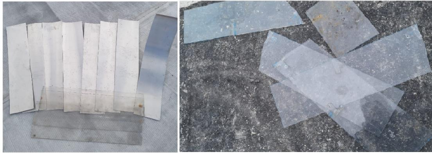
Figura 25. Recorte de Piezas de Reemplazo de las Hélices de Acrílico
