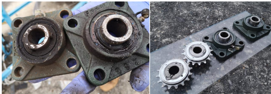
Figura 26. Limpieza y engrase de piezas mecánicas y móviles
