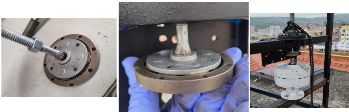
Figura 30. Mecanismo de Giro del Eje del Generador Eólico Vertical
