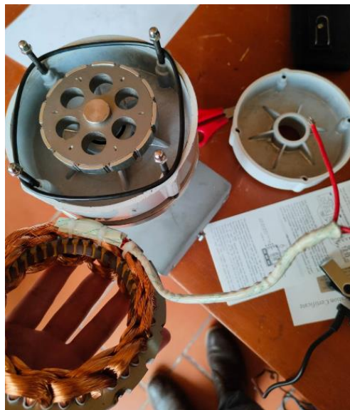
Figura 22. Cambio de Cables de Conexión del Generador Eléctrico
