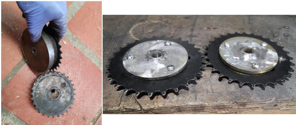
Figura 28. Cambio de Engranes de los Ejes de Giro
