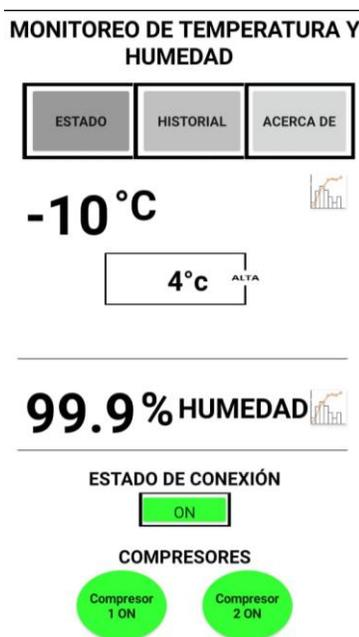
Figura 4-5. Aplicación móvil versión previa de monitoreo en planta de temperatura y humedad
