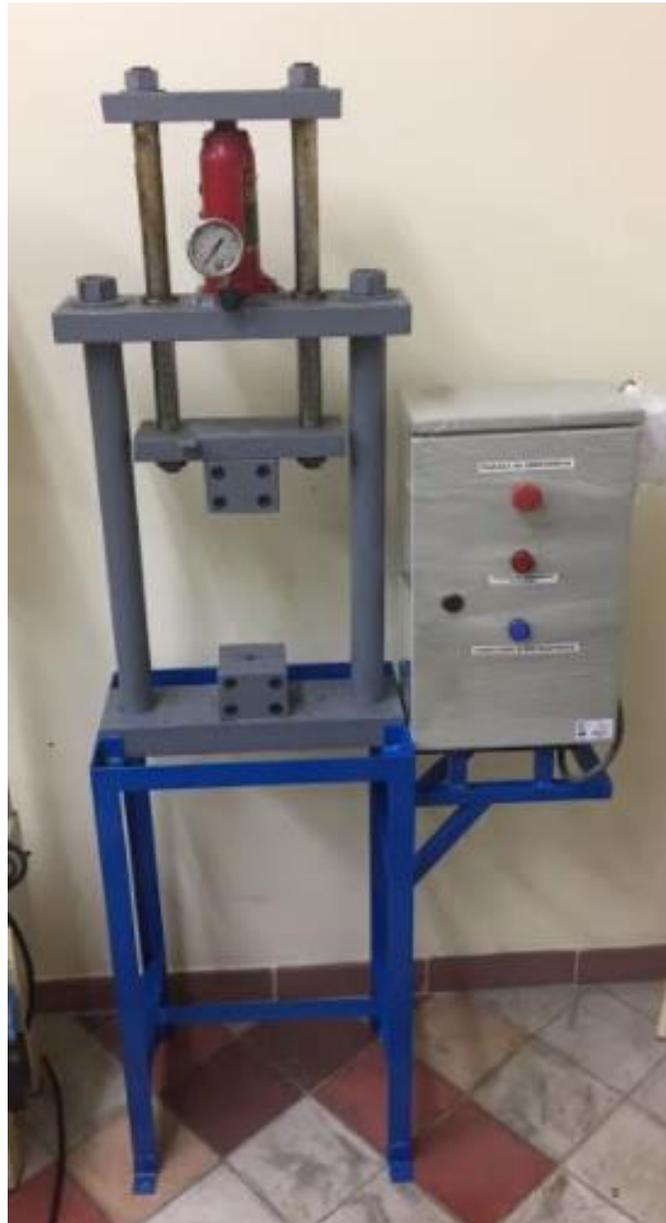
**Fuente:** Moron j & Murallas c. desarrollo de un sistema de control de temperatura y supervisión de la presión aplicada a la máquina de ensayos de termofluencia del laboratorio de materiales de la Universidad Antonio Nariño sede Bucaramanga, a través del desarrollo de una interfaz HMI mediante el software Labview y un microcontrolador ATMEGA 2560. Universidad Antonio Nariño sede Bucaramanga, p. 46.
