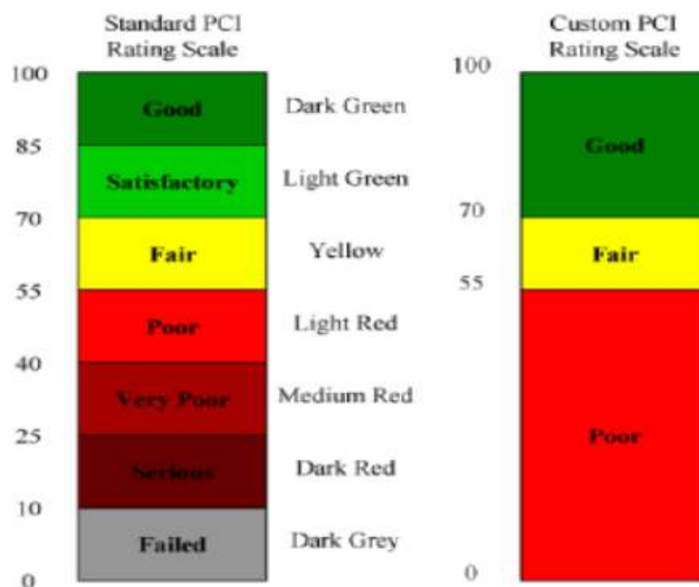
Figura 27. Escala estándar y específica de valores y colores del Pavement Condition Index (PCI) (ASTM International, 2007).
