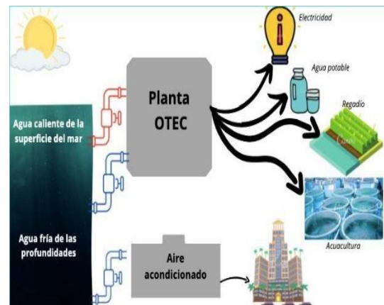
Figura 21 Diversos usos y subproductos de una planta OTEC [22]
