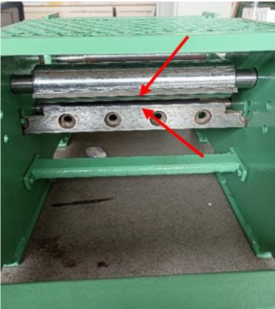
Fig.18. Sistema de corte conformado por una cuchilla móvil y una cuchilla fija.
