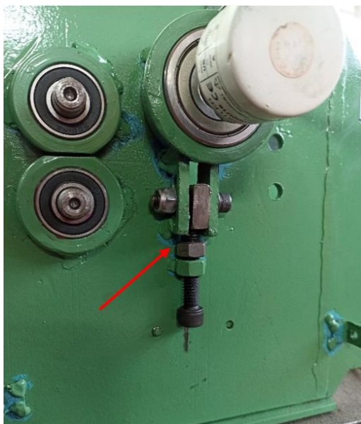
Fig.20. Sistema de calibración de la cuchilla inferior.
