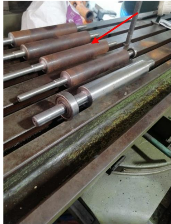
Fig.12. Rodillos fabricados en taller mecanizado.
