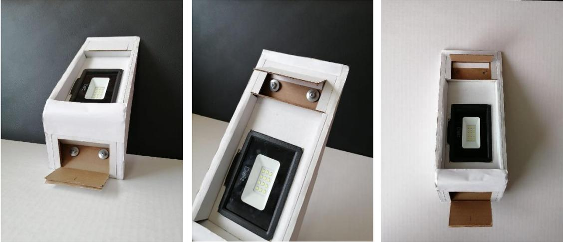
Se realiza un prototipo a escala real del panel de luz, teniendo en cuenta sus sistemas de anclajes y su interior.
