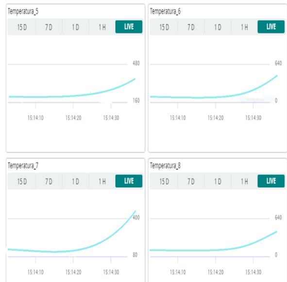
Fig.38 Graficas prueba #2, camión 2357 banco derecho, después de cambiar inyector #13 en mal estado.
