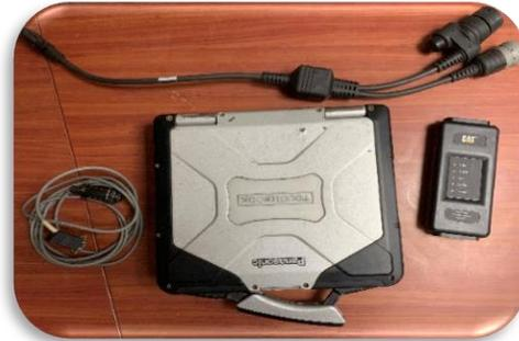
Fig. 3 Adaptador comunicador Caterpillar, cables de conexión y laptop.
