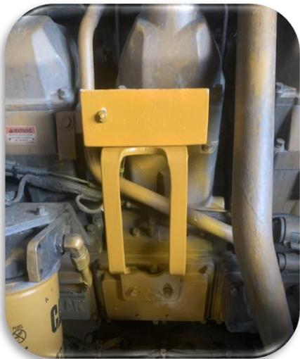
Fig.28 Instalación de soporte para carcasa de arduino.
