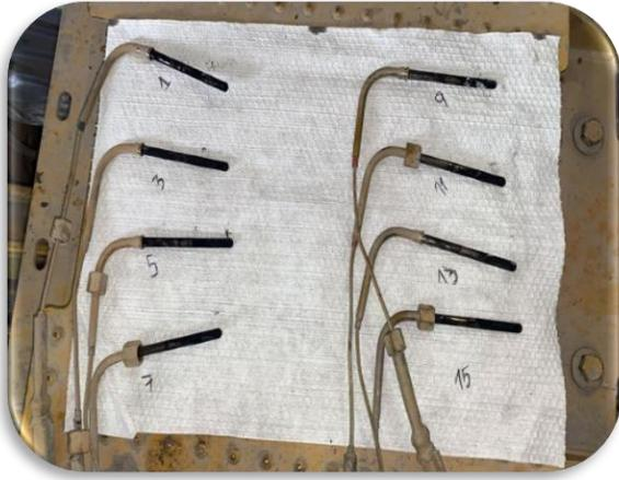
Fig.6 Termopares tipo K
