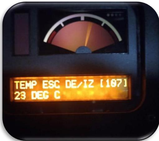
Fig.4 Pantalla de Vims, (Vital information management sistema) camión 793 Caterpillar.
