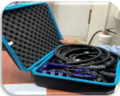
Fig.7 Prototipo sistema para medir la temperatura de gases de escape en los cilindros del motor diésel Caterpillar 3516B para el diagnóstico de inyectores.
