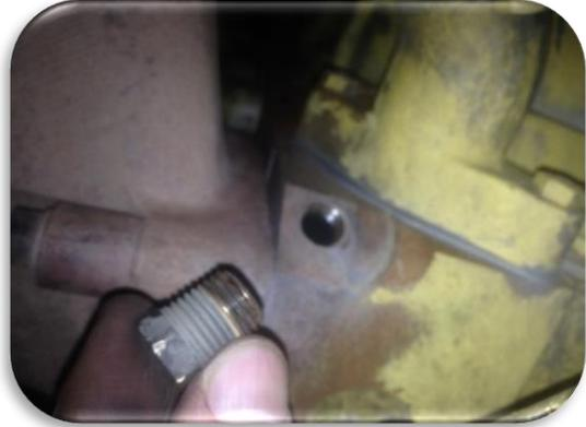
Fig.29 Galería de escape en culata donde va instalada el termopar.
