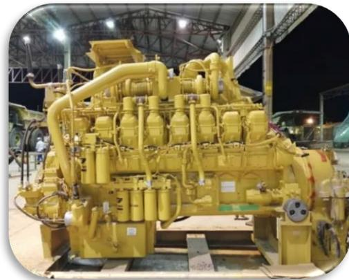
*Fig.1 Vista lateral izquierda del Motor diésel Caterpillar 3516B*
