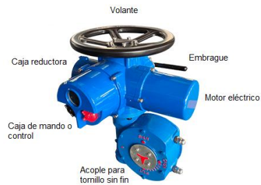
Figura 23. Accionamiento eléctrico para compuertas
