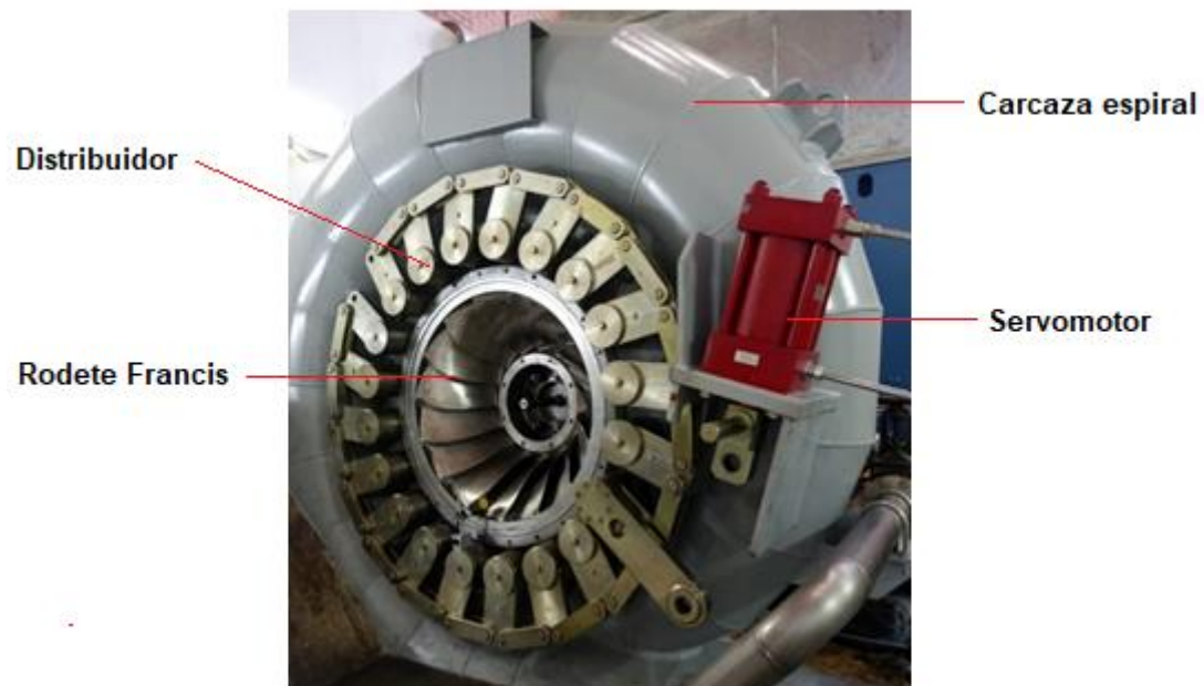
Figura 12. Conjunto turbina y rodete Francis
