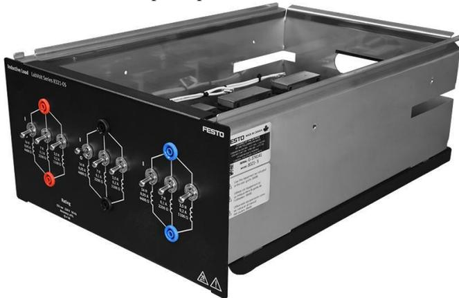
Fig. 9 carga banco de carga inductiva
