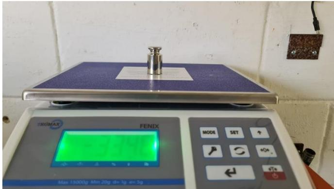
Tabla 13 – Calibración balanza (carga ascendente)
