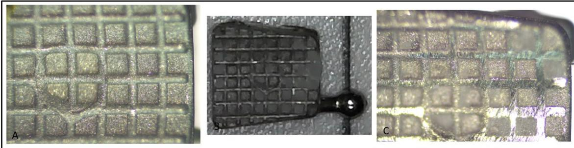
(A) bracket nuevo, (B) mismo bracket descementado, (C) Bracket reacondicionado con técnica de fresado.
