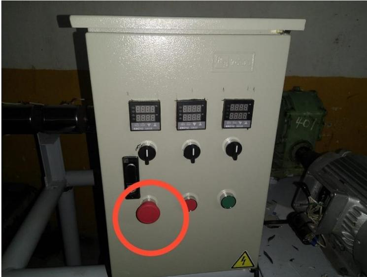
Después de hacer una verificación del sistema, se procede a dar un giro para deshabilitar la opción, quedando nuevamente para continuar con el proceso.
