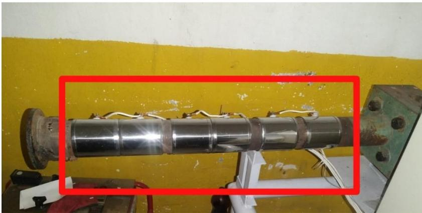
Pasado una hora aproximadamente la temperatura es ideal para extruir. **Importante: no arrancar el motor estando las resistencias a temperatura ambiente ya que puede ocasionar daños internos al extrusor.**
