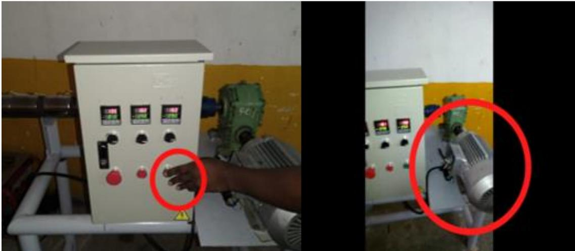
**Séptimo paso:** si se presenta una anomalía en el sistema, se pulsa el botón parado de emergencia, deshabilitando el suministro de energía en el cofre de automatización, quedando en un estado de seguridad para su manipulación.
