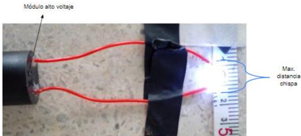
Figura 38. Determinación del voltaje generado por el módulo de alto voltaje.
