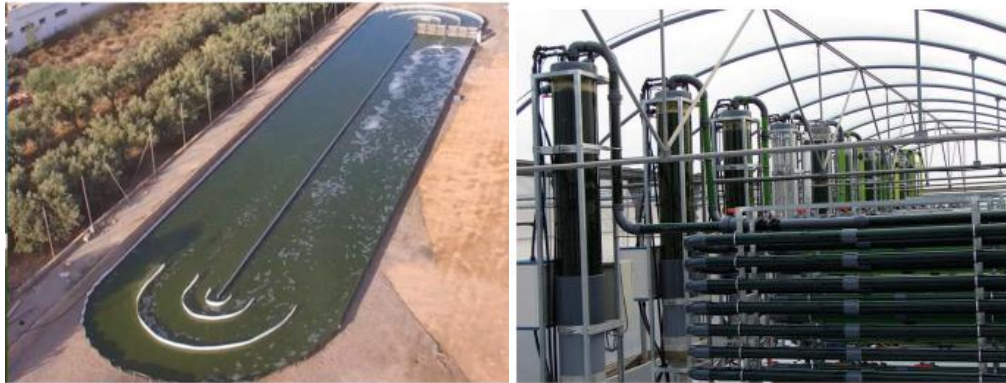
Figura 15. Fotobiorreactores usados para el cultivo de microalgas. Izq. Reactor tipo carrera. Tomado de (Inostroza et al., 2021). Der. Fotobiorreactor tubular. Tomado de (de Andrade et al., 2016).
