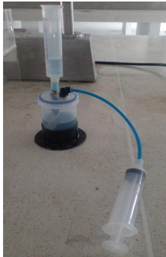
Figura 23. Dispositivo medición de biogás por desplazamiento de líquido. Dispositivo fabricado en el Laboratorio de Ingeniería Ambiental en trabajos previos.
