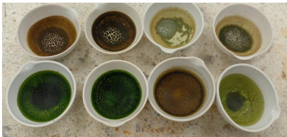
Figura 36. Ensayo de sólidos volátiles para las muestras de los diferentes ensayos de concentración celular. Arriba de izquierda a derecha coagulante hierro, coagulante aluminio, electrocoagulación electrodos de hierro y electrocoagulación electrodos aluminio. Debajo de izquierda a derecha sedimentación, pH base, pH ácido, sal inorgánica.
