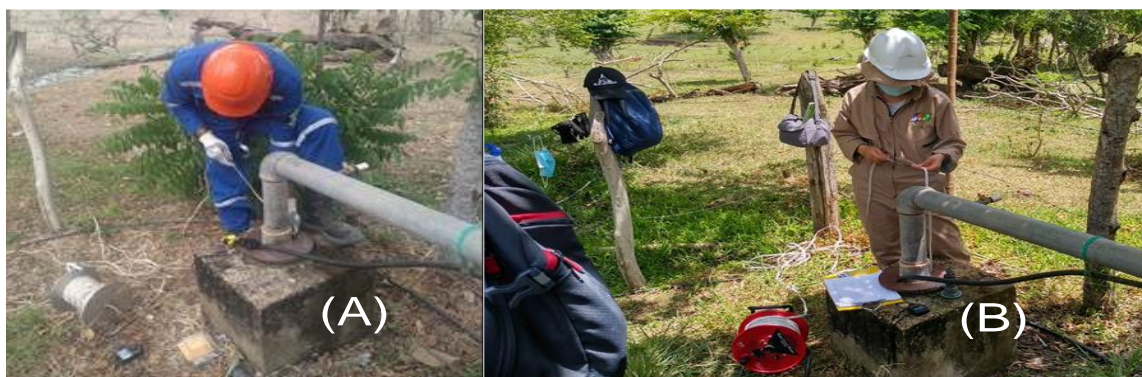
Pozo profundo (PZ 101) localizado en la finca La Victoria, municipio de Sincé, Sucre. (A) prueba pre registro. (B), pos registro sísmico
